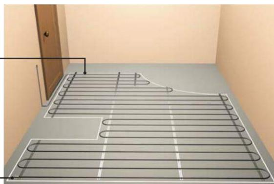
8. Вложіть гофровану трубку в штробу від отвору терморегулятора на підлогу так, щоб кінець, в якому буде знаходитись термодатчик температури підлоги був на відстані 50-100 см від стіни та посередині між витками кабелю. Рекомендовано розташовувати датчик температури як можна ближче до поверхні підлоги. Для цього, перед заливкою, зафіксуйте нижній кінець трубки з датчиком на необхідній висоті.
